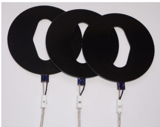
Рисунок 2. Подизоляторные датчики высокого напряжения
